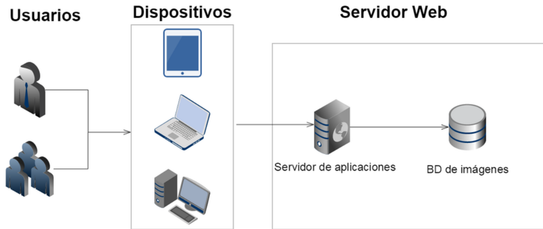
Figura 2 Arquitectura Cliente-Servidor. Extraída de [3]
